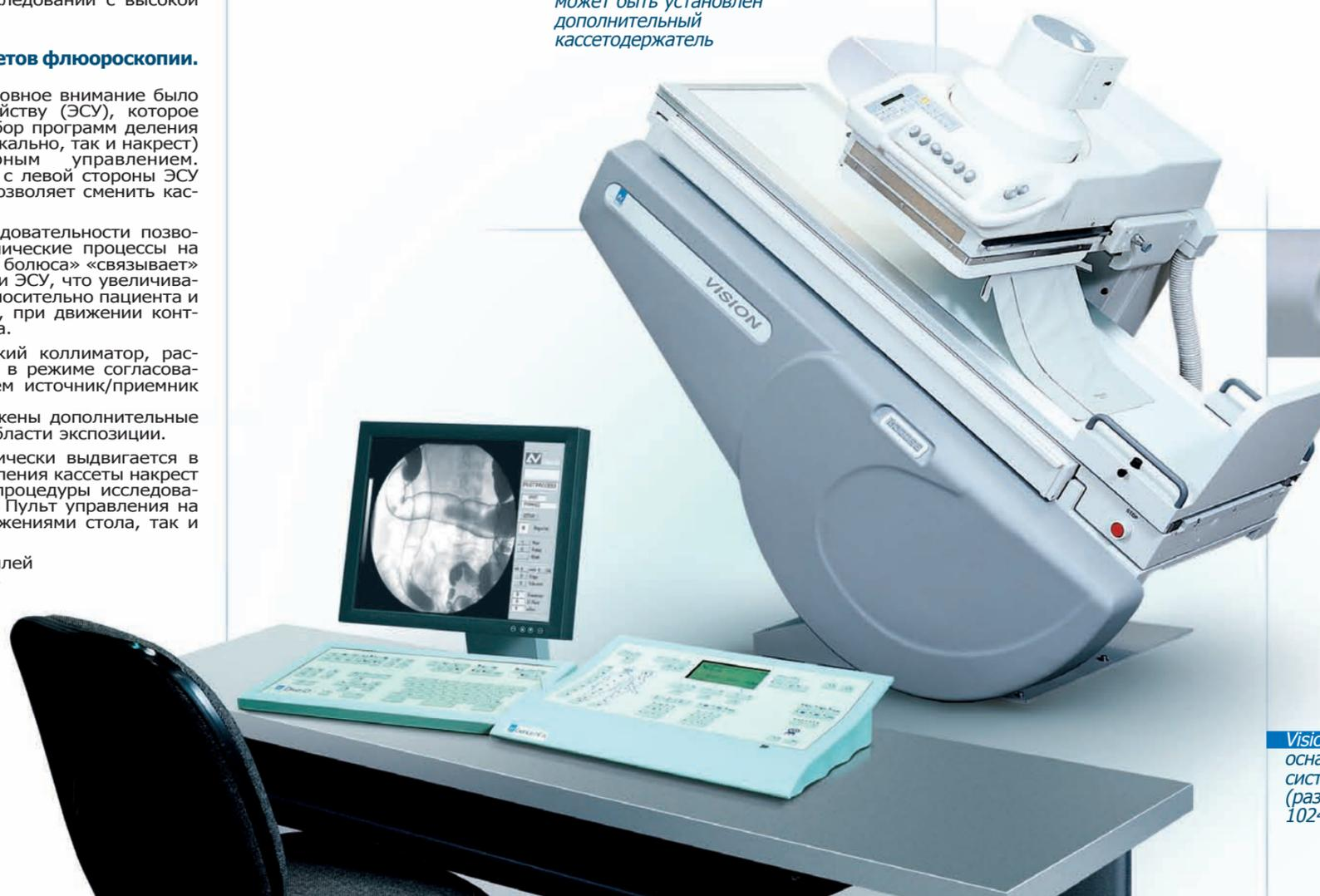
*Vision может быть оснащен цифровой системой DIVA-D (размер изображения 1024 x 1024 пиксела)*
